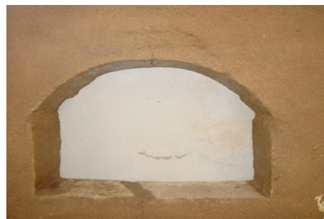
(b) 毛洞 M1 断面破坏形态
