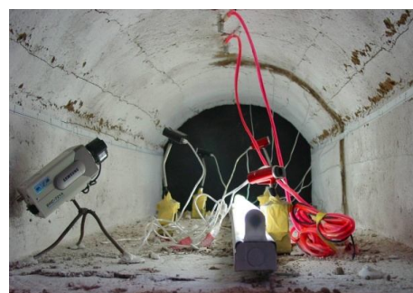
(a) 毛洞 M1 洞壁破坏形态
